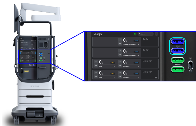
Figura 3 Conectores bipolares E-200, mostrados em um gerador integrado
