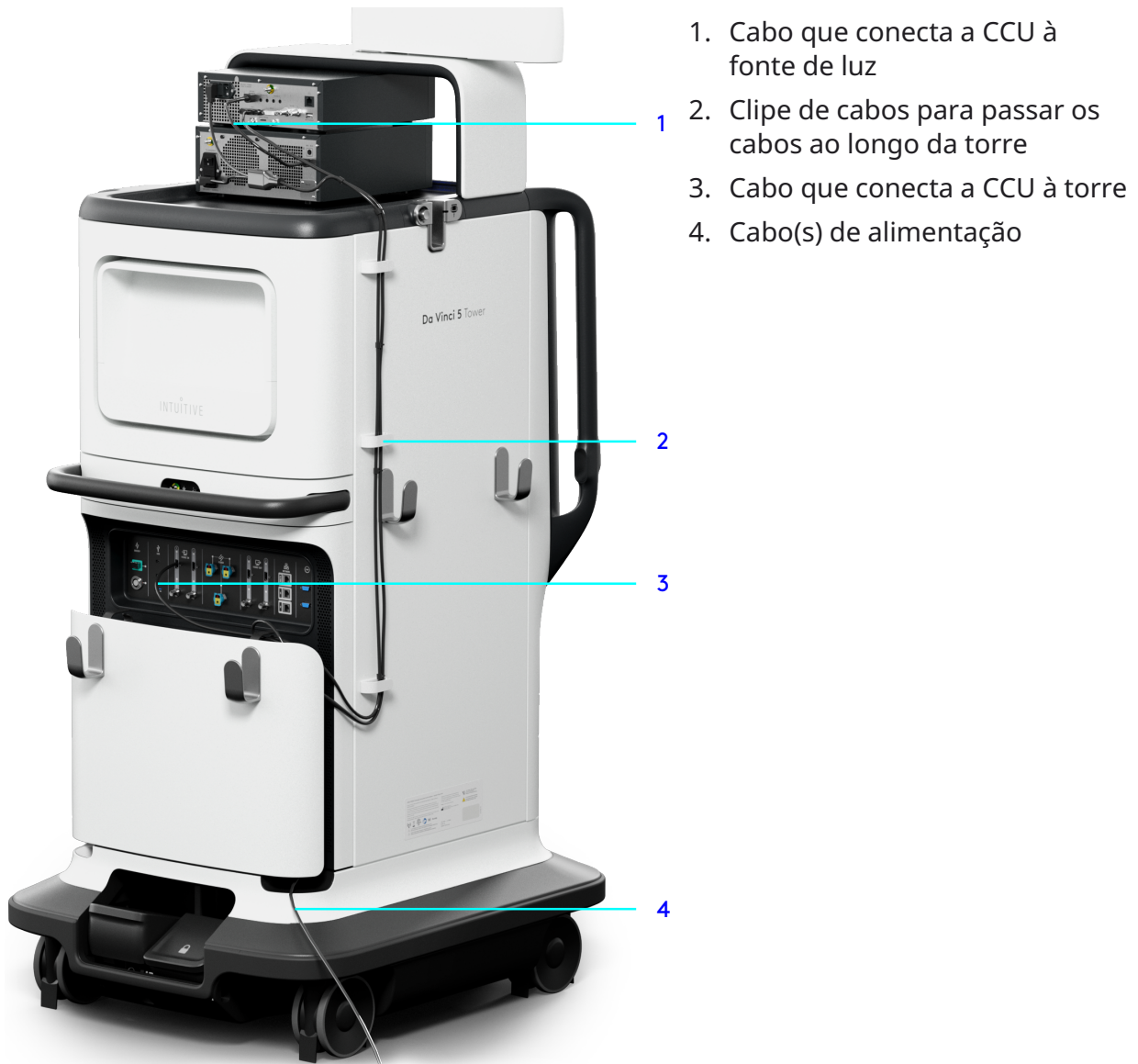
Figura 4 Gerenciamento de cabos das unidades de controle da câmera e da fonte de luz (exemplo)
