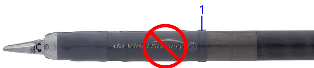
Figura 13 Cobertura da ponta instalada além da posição correta
