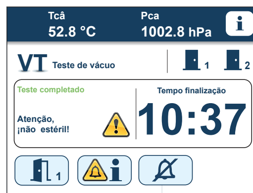
Figura 8.17 - Fim do ciclo de ensaio sem falha
