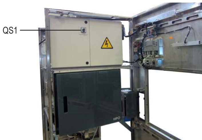
Figura 10.2 - Interruptor principal do esterilizador no modelo 130HPO®
