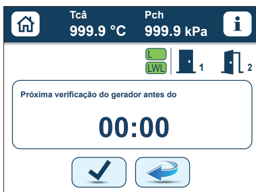
Figura 8.66 - Verificação do gerador de vapor
