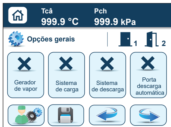
Figura 10.9 - Gerador de vapor desativado
