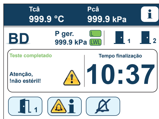
Figura 8.17 - Fim do ciclo de ensaio sem falha
