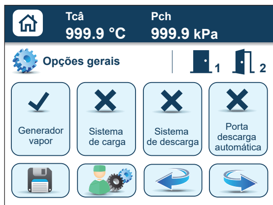
Figura 10.10 - Gerador de vapor ativado
