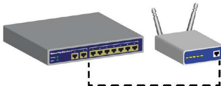
Figura A.4 Dispositivo de Segurança de Rede com Ponte Sem Fio
