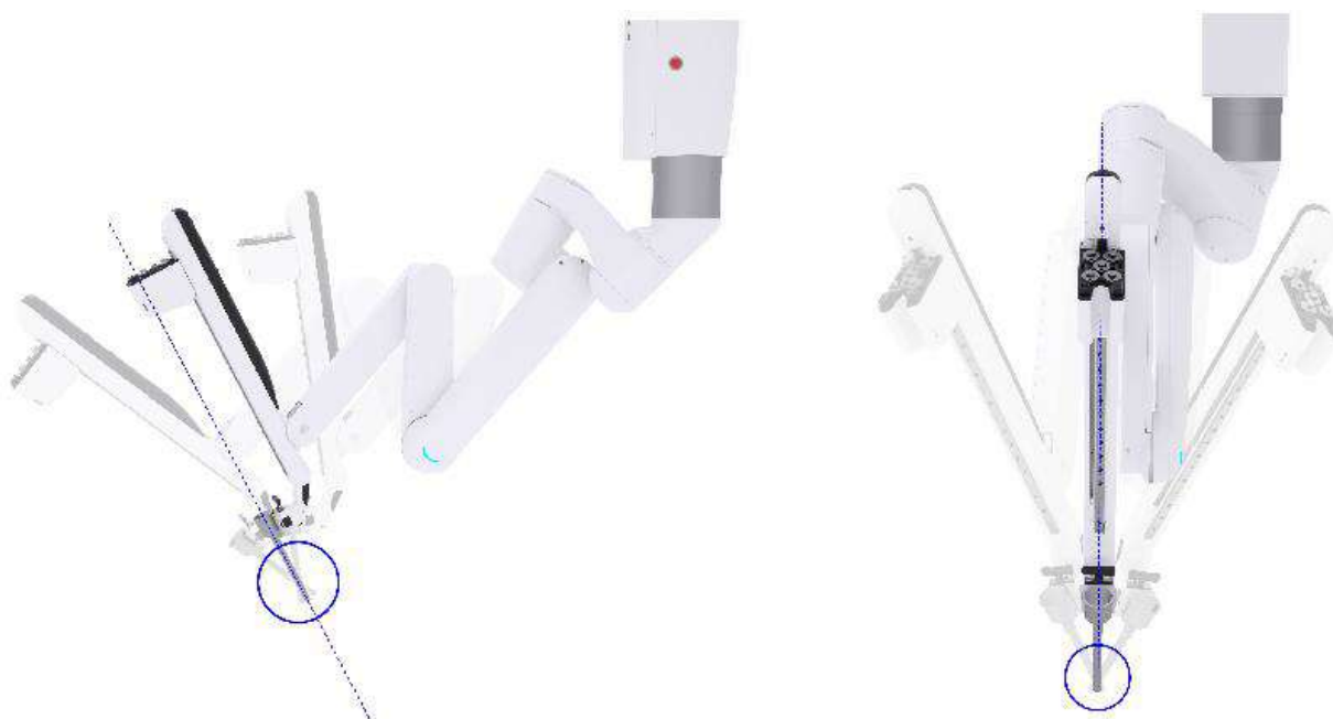
Figura 9.16 Exemplos de movimento da embreagem do instrumento
