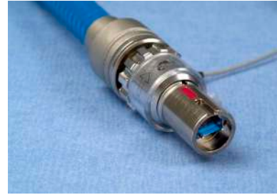
Tampa da extremidade retirada do cabo do sistema
