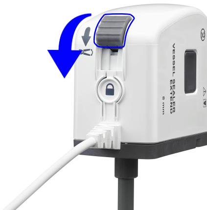
3. Trave as mandíbulas na posição aberta segurando o deslizador de liberação da pega no fim de seu curso de movimento, pressionando e mantendo pressionado o botão de trava e, em seguida, soltando o deslizador.
