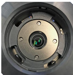
Figura 3 Alavancas de liberação pressionadas – cliques retentores retraídos
