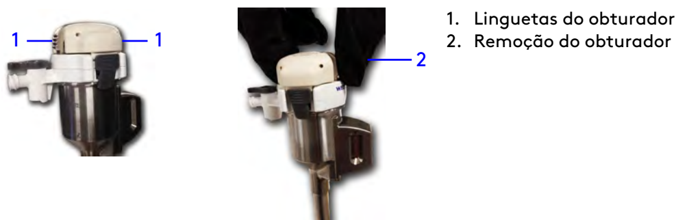
Figura 11.15 Remoção de obturador
