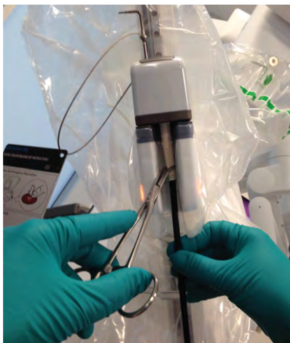
Figura 2.6 Usando uma pinça, torça a engrenagem de rolagem enquanto segura o eixo no lugar
