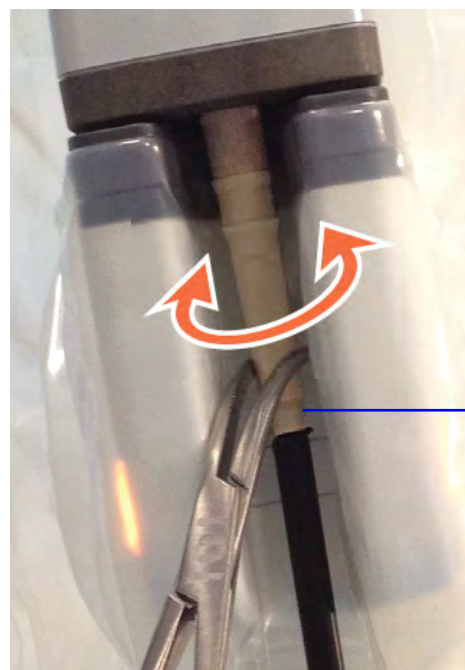
Figura 2.6 Usando uma pinça, torça a engrenagem de rolagem enquanto segura o eixo no lugar
