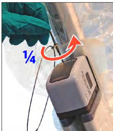
Figura 2.4 Mantenha a ferramenta de liberação de pega engatada enquanto abre manualmente as pegas
