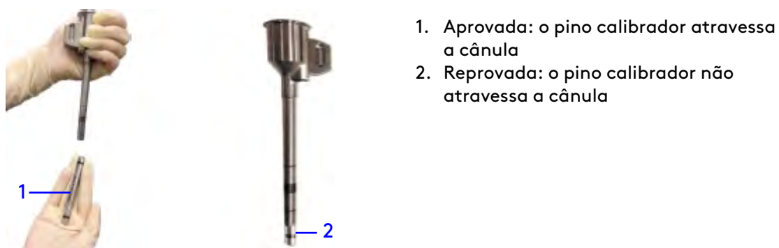
Figura 11.9 Exemplos de aprovação e reprovação com o pino calibrador
