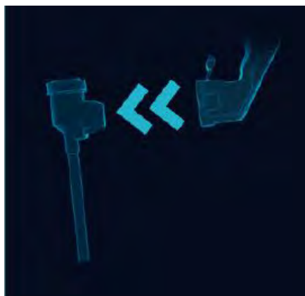
Figura 9.14 Acople todos os braços (mostrado no Carrinho de Visão)
