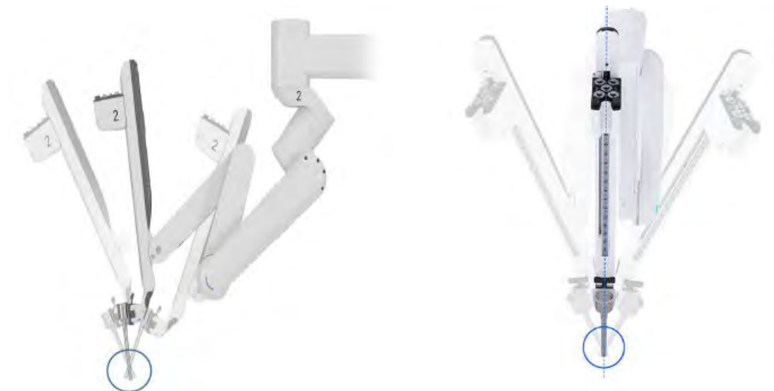
Figura 9.6 Exemplos de movimento da embreagem do instrumento
