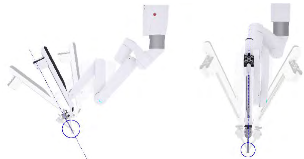
Figura 9.16 Exemplos de movimento da embreagem do instrumento
