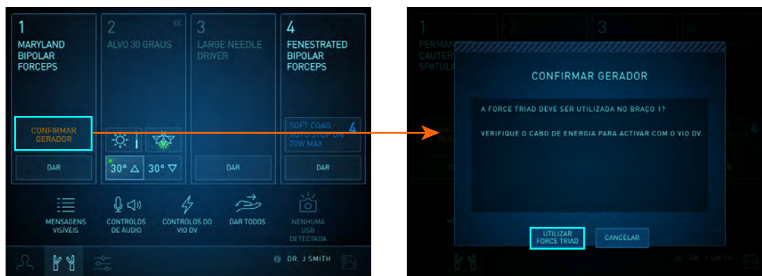
Figura 10.33 Após a troca do instrumento, confirme manualmente a conexão ao ForceTriad, exemplo
