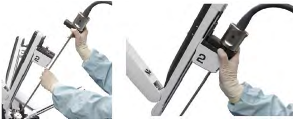
Figura 7.16 Introdução do endoscópio dentro da cânula e do adaptador estéril
