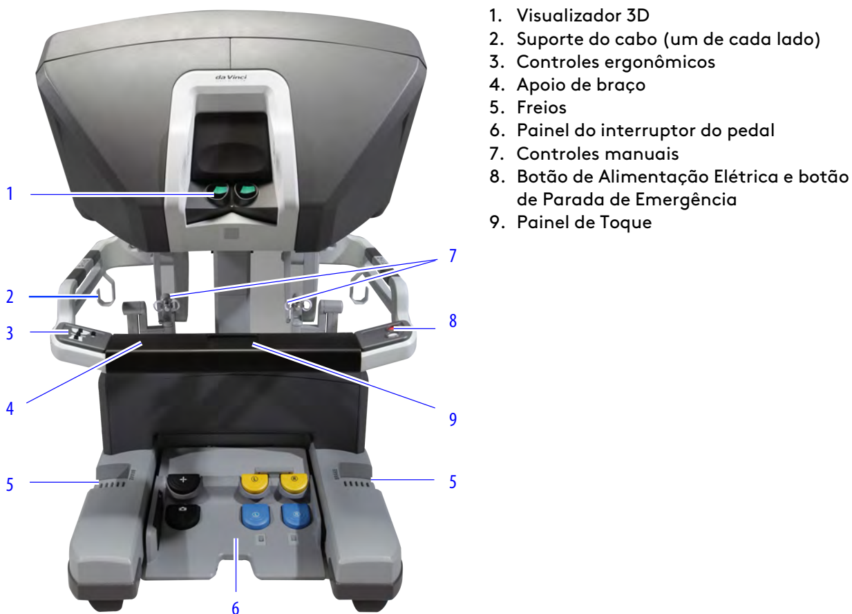
Figura 10.1 Console do Cirurgião
