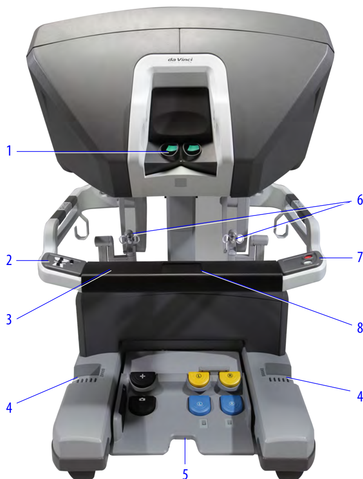
Figura 2.2 Console do Cirurgião
