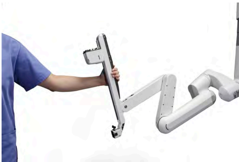
Figura 9.14 Segure o braço pela alça cinza e mova conforme desejado.
