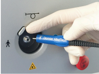
Figura 18: Conecte o condutor de luz
