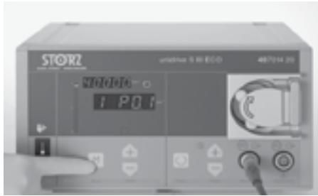
La sélection des prises pour moteur s'effectue à l'aide de la touche M ③. L'actionner de façon prolongée (>1,5 s) pour passer à l'autre prise pour moteur.
