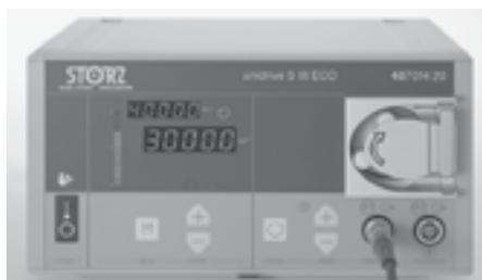
Lorsque la pièce à main est connectée via la pédale droite de l'interrupteur, la pompe démarre automatiquement et achemine la quantité de liquide d'irrigation préréglée.
