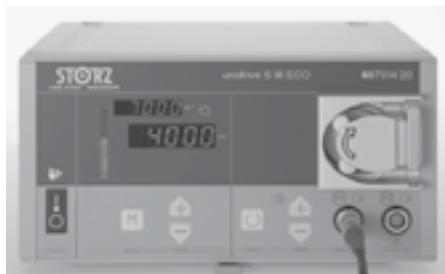
Si la mise en route de la pièce à main s'effectue via la pédale droite de l'interrupteur, la pompe démarre automatiquement et achemine la quantité de liquide d'irrigation préréglée.
