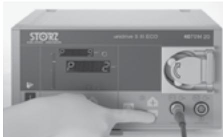
Lorsque la pièce à main est connectée via la pédale de droite de l'interrupteur, la pompe démarre automatiquement et achemine la quantité de liquide d'irrigation préréglée.
