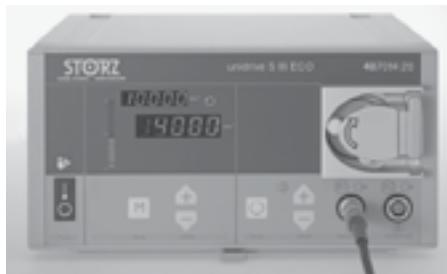
Si l'on active la « pièce à main » avec la pédale droite de l'interrupteur, l'affichage à barres ② et l'afficheur ⑤ s'actualisent et affichent la vitesse de rotation actuelle.
