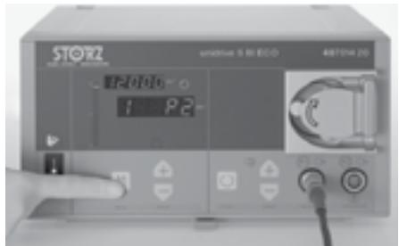
La touche M ③ permet maintenant de sélectionner la fraise à sinus DRILLCUT-X® ou le shaver DRILLCUT-X®.
