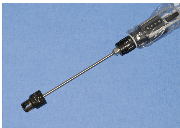
Figura 7.16 Alvo de alinhamento e ponta do endoscópio introduzidos, alvo centrado no ecrã
