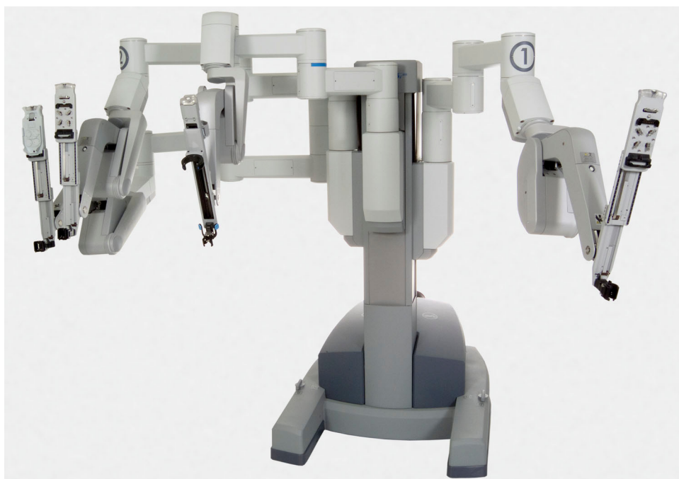
Figura 5.4 Braços de instrumentos estendidos para colocação de panos cirúrgicos
