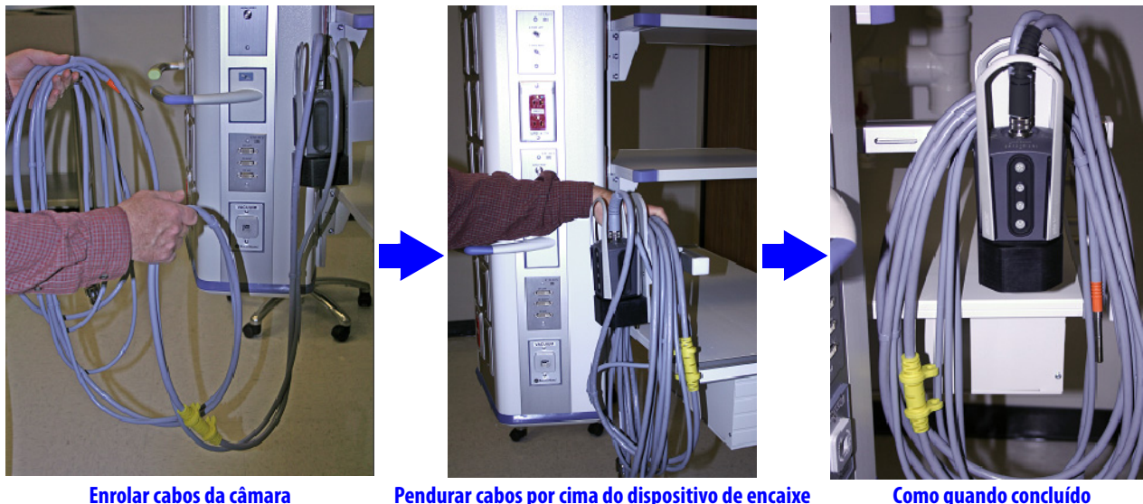
Figura D.12 Câmara e armazenamento de cabos com o dispositivo de encaixe montado na lança de transporte
