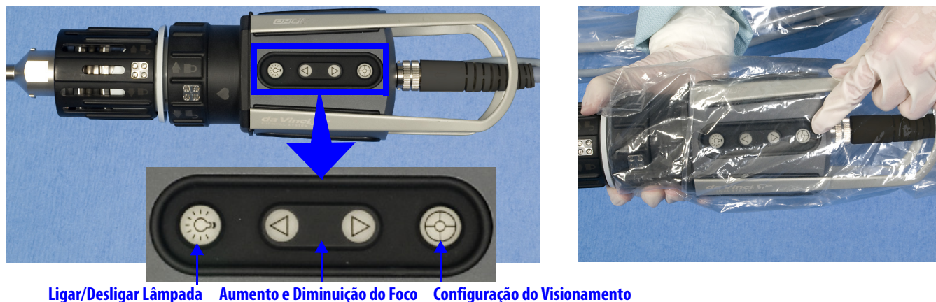
Figura 7.6 Botões da cabeça da câmara, ilustrados com panos cirúrgicos à direita
