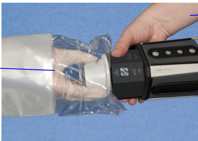
Figura 6.21 Encaixe a cabeça da câmara no adaptador esterilizado
