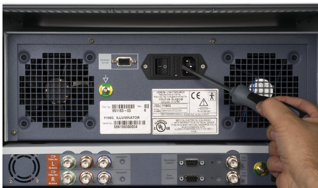
Figura C.6 Remova a cobertura dos fusíveis
