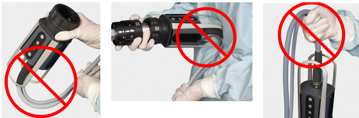
Figura 7.4 Exemplos de manuseamento indevido dos cabos da cabeça da câmara
