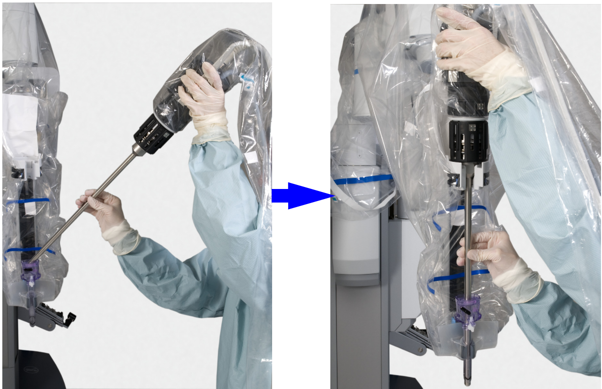
Figura 9.16 Instalação do endoscópio no braço da câmara
