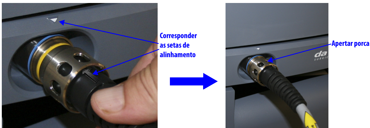
Figura 4.7 Ligação do cabo da câmara à CCU
