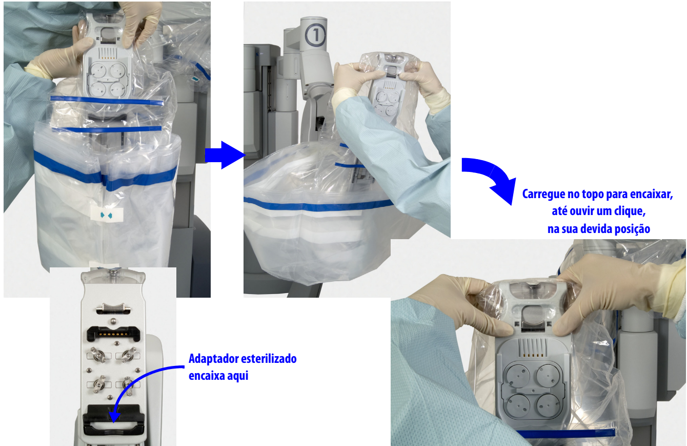
Figura 6.10 Introduza a base e prima o topo para instalar o adaptador esterilizado
