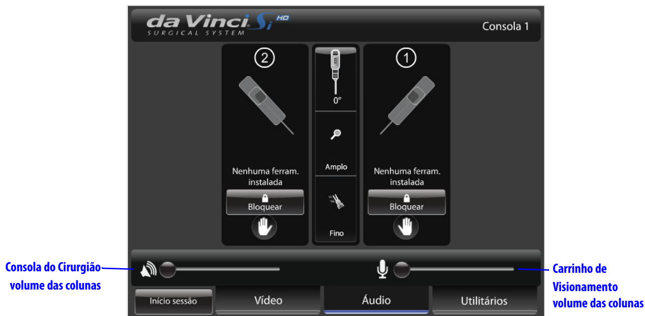
Figura B.2 O controlo do volume da coluna está no botão Áudio do painel tátil
