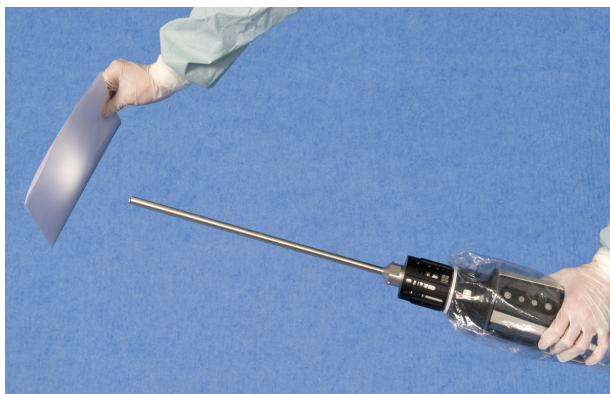
Figura 7.9 Utilização do papel para configurar o balanceamento branco
