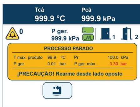
Figura 6.11 - Tela de rearme do equipamento (parada de emergência ZE)
