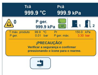
Figura 6.7 - Tela de rearme do equipamento (parada de emergência ZNE)
