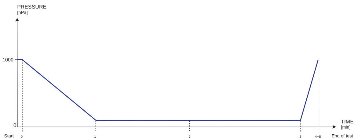
Figura 7.4 - Perfil de pressão no Teste de vácuo
