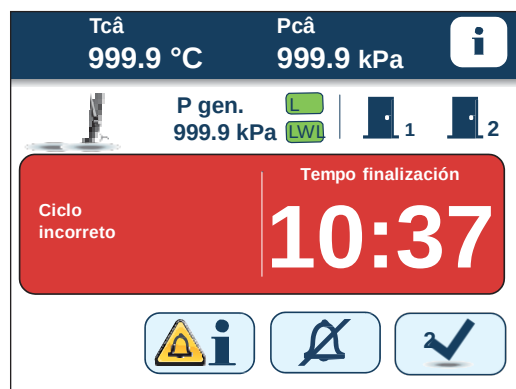
Figura 8.17 - Fim de ciclo incorreto sem confirmar
