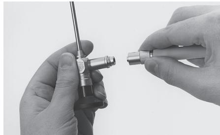
Brancher le conducteur de lumière sur l'endoscope (en tournant la vis moletée d'un quart de tour sur le culot Edison).
