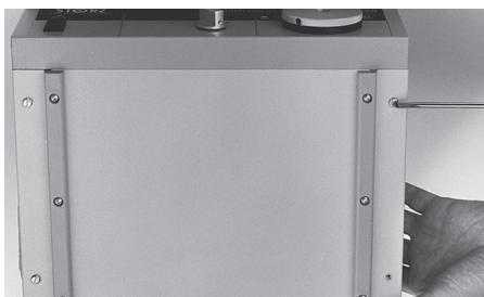
Desserrer les 4 vis placées en dessous de l'appareil.
