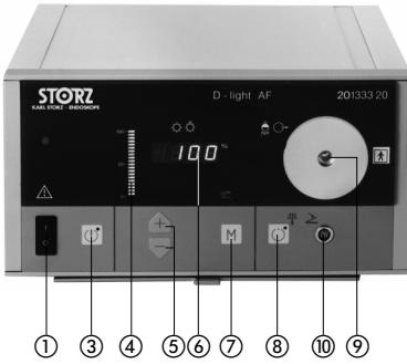
**Option SCB – 201333 20-1 :** Brancher le câble SCB sur l'une des prises ⑩, les deux prises étant identiques. Brancher l'autre extrémité du câble sur une unité de commande SCB® de KARL STORZ, ou sur d'autres appareils SCB.
