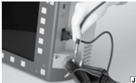
4. Brancher le tuyau de la bouteille d'eau (intégré dans le couvercle) sur le connecteur d'alimentation de l'endoscope vidéo (voir photo J).
