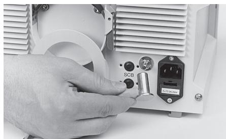
L'appareil est équipé d'une prise de compensation de potentiel ⑧.
