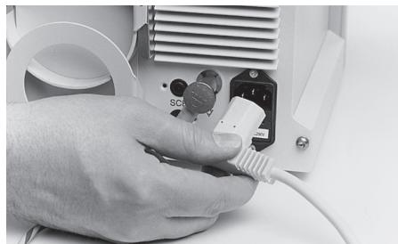
Ne brancher l'appareil que sur le voltage indiqué sur la plaque signalétique.
