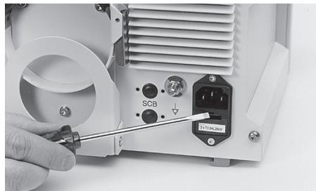
Rimuovere il portafusibili di rete ② mediante un cacciavite o un altro utensile adeguato.
