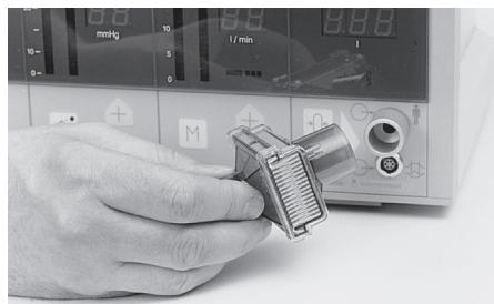
Emboîter le filtre à gaz por CO<sub>2</sub> stérile sur le raccord d'insufflation ⑬.
