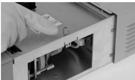
Rabattre le couvercle de la lampe : Cela ferme le compartiment de lampe. Sécuriser ensuite le tout à l'aide du raccord rapide (le faire tourner de 90° dans le sens des aiguilles d'une montre).
