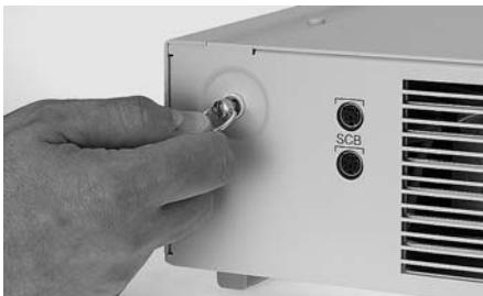
Refermer le boîtier et serrer le raccord rapide (rotation de 90° dans le sens des aiguilles d'une montre).
