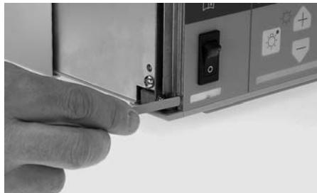
Retirer la bande d'identification en anglais et glisser la bande d'identification sélectionnée entre la feuille décorative et la tôle avant.
