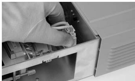
Déverrouiller le connecteur de la lampe en appuyant des deux côtés et retirer simultanément le connecteur en tirant avec précaution.
