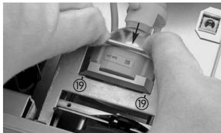
Appuyer avec force sur la fixation de lampe à l'aide des index gauche et droit pour la pousser en douceur d'environ 2 mm vers l'avant (voir la direction de la flèche sur la photo), jusqu'à ce que le qu'elle se désenclenche du mécanisme de verrouillage ⑯.
