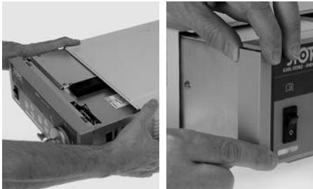
Repousser le couvercle de l'appareil (voir aussi la section « Changement de lampe » à la page 22), puis retirer le panneau frontal qui est verrouillé à gauche.
