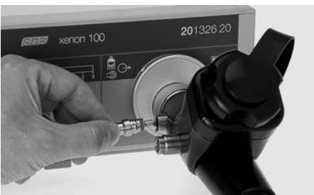
Raccorder le tuyau de la bouteille d'eau (intégré dans le bouchon) au connecteur d'alimentation de l'endoscope (raccord de bouteille de liquide d'irrigation).
