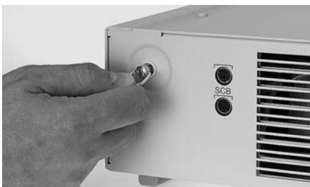
Ouvrir l'enceinte. Desserrer les 2 raccords rapides au dos de l'appareil en effectuant une rotation de 90° dans le sens inverse des aiguilles d'une montre.
