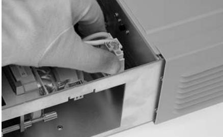
Brancher le connecteur de la lampe dans la prise de l'appareil prévue à cet effet jusqu'à ce que les crochets s'enclenchent (possible dans une seule position).
