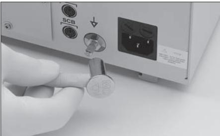
L'appareil est équipé d'une fiche de compensation de potentiel ⑭. Confier, le cas échéant, le branchement à la terre à un personnel compétent.
