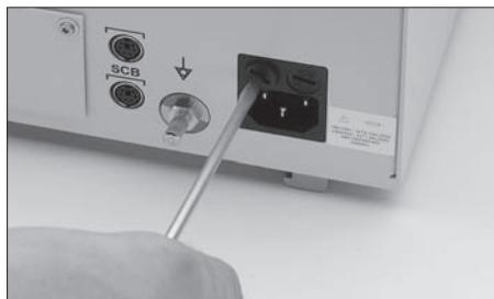
Retirer le support de fusibles ⑯ à l'aide d'un tournevis fin (extrémité d'environ 6 mm de large) ou d'un autre outil approprié.
