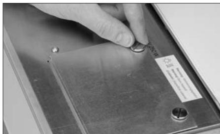
Retirer le couvercle du compartiment de lampe. Desserrer pour cela les vis moletées.
