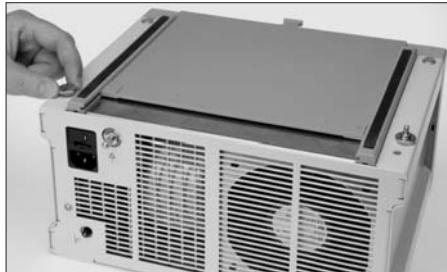
Ouvrir l'enceinte. Commencer pour cela à dévisser les 2 vis moletées en dessous de l'appareil.
