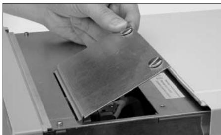
Remettre le couvercle du compartiment de lampe en place.
