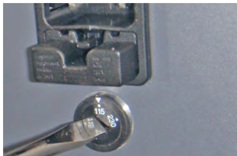
Imagem 3-9 Tensão de rede ajustada para 115 V
