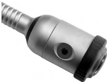
Imagem 1-4 Aplicador F-SW com elemento de acoplamento I (curto) para profundidade de foco de 30 mm
