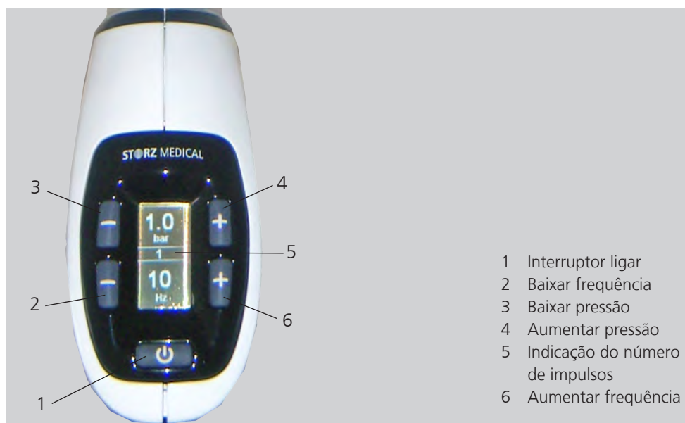
Imagem 1-4 Elementos de comando e de indicação no aplicador
