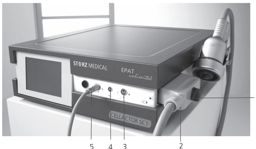
Ilustração 2 - 12 Tomadas de conexão para aplicadores e disparadores acionados pelo pé
