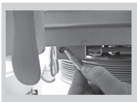
Figura 4-9 Ligação à parte dianteira da mesa de tratamento
