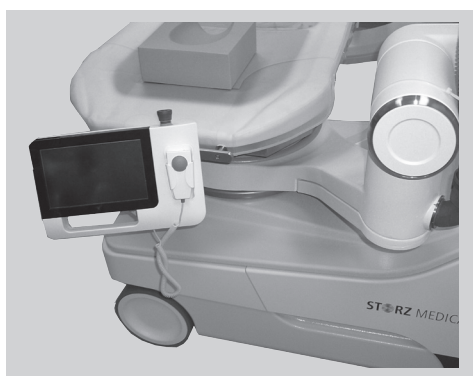
Figura 4-4 Painel de controlo na calha normalizada da parte da cabeceira
