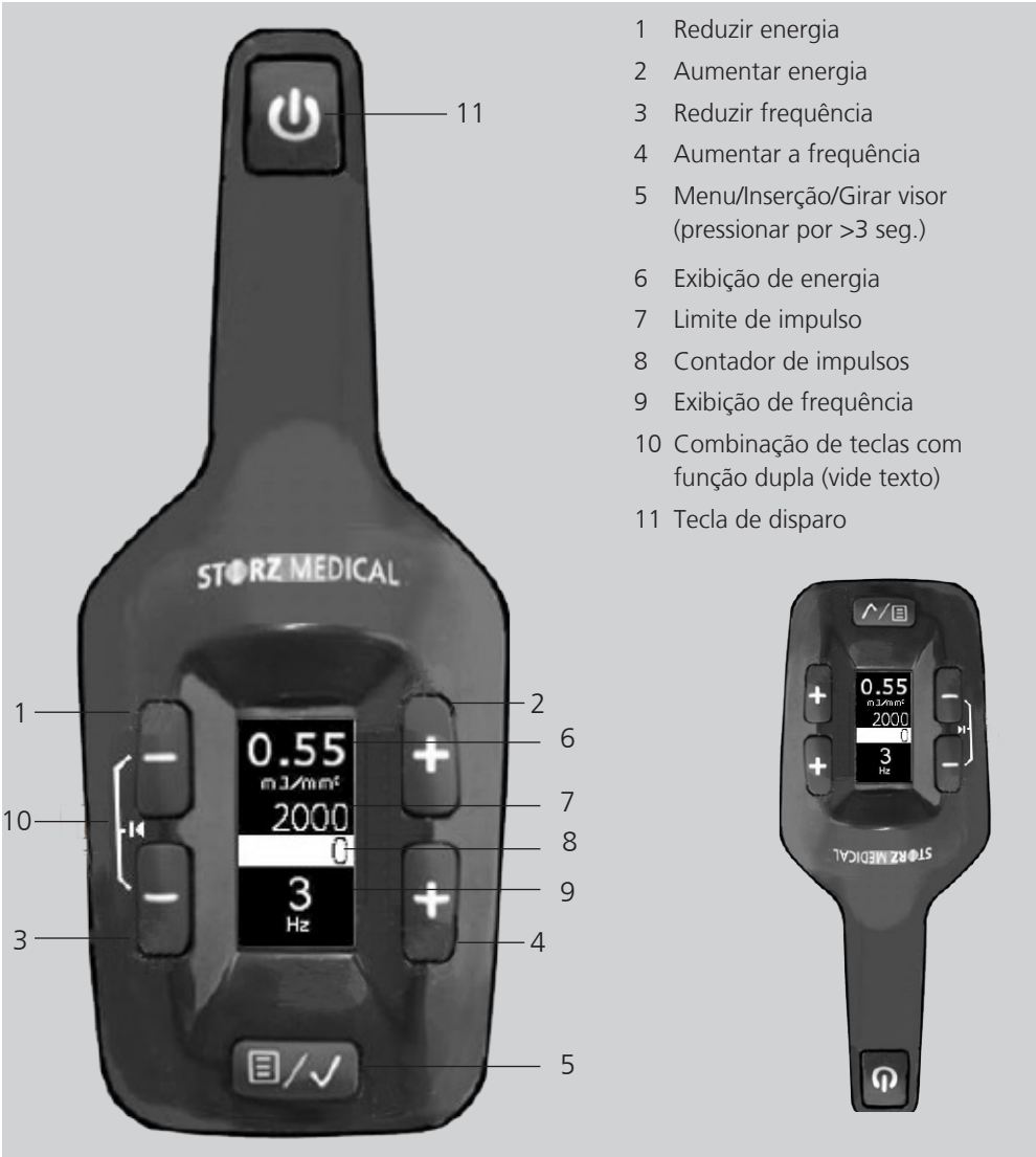
Imagem 4-2 Visor e botões de ajuste do aplicador F-SW
