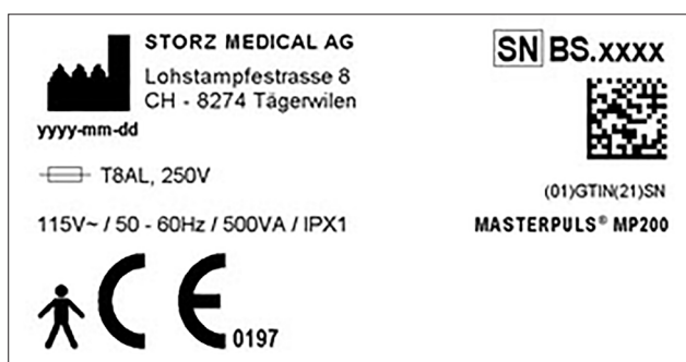
Imagem 7-2 Placa de identificação tensão de alimentação 115 VCA
