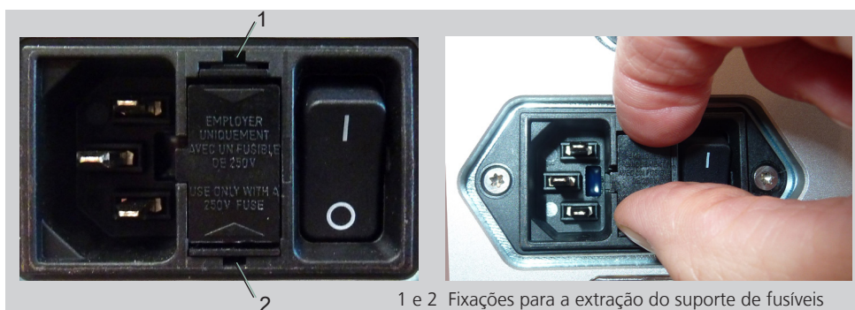
Imagem 5-1 Tomada para conexão à rede, suporte de fusíveis, tecla de ligação
