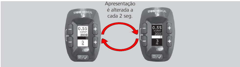
Imagem 3-2 Troca automática entre variantes de exibição A a B
