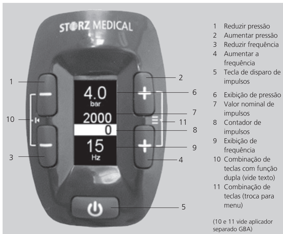
Imagem 4-2 Visor e teclas de ajuste do aplicador D-ACTOR
