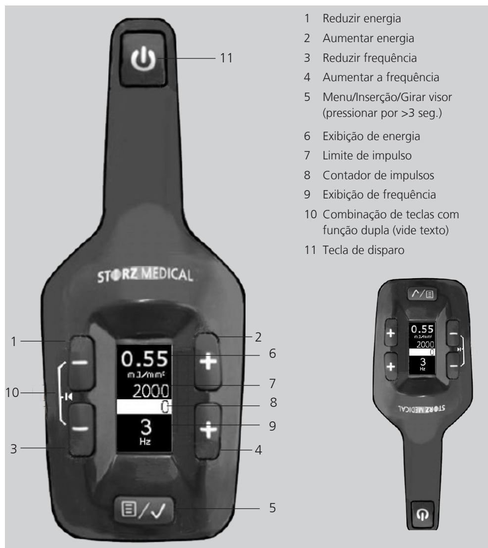
Imagem 4-2 Visor e botões de ajuste do aplicador C-ACTOR
