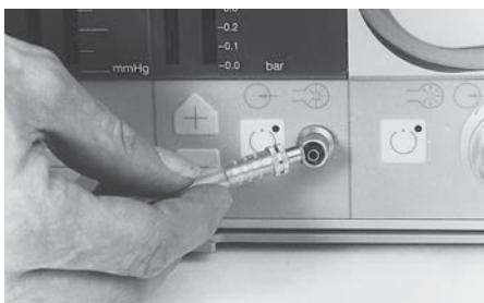
Brancher le deuxième tuyau d'aspiration sur la prise de l'appareil ⑭.
