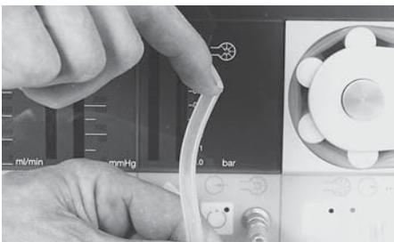
Fermer le tuyau d'aspiration tuyau à instruments avec le doigt et vérifier si un vide se forme. La pression d'aspiration indiquée sur l'affichage de valeur réelle ⑦ doit être identique à la valeur théorique sélectionnée (affichage ⑧).
