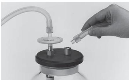
Ligue o conector de aspiração ⑯ da garrafa de aspiração por meio do tubo flexível de aspiração em silicone ao conector de aspiração do instrumento.
