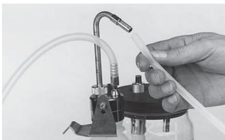
Relier la tubulure longue et coudée du bouchon de la bouteille ⑥ et le tube d'aspiration/d'irrigation ou la pièce à main d'aspiration/d'irrigation à l'aide du deuxième tuyau.
