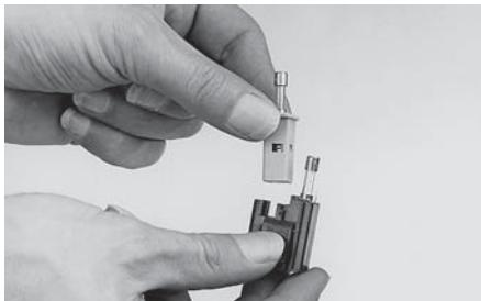
Retirer le porte-fusibles de secteur ⑩ et extraire le module sélecteur de voltage. Réinsérer ce module dans le porte-fusibles en veillant à ce que le voltage indiqué au dos dans le voyant corresponde à l'alimentation locale.
