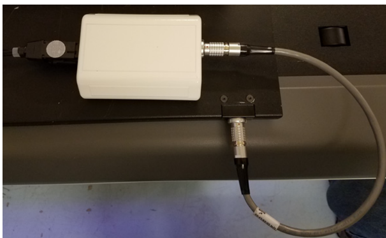
Hub de conexão com cabo de fibra ótica e cabo de mesa conectados
