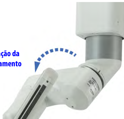
Figura 3.7 Exemplo de posição da junta de espaçamento do paciente no da Vinci Xi
