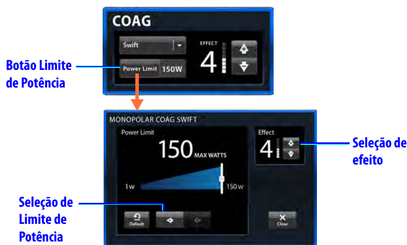
Figura 6.12 Configurações de limite de potência, exemplo de COAG monopolar
