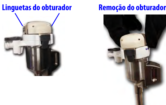
Figura 11.15 Remoção de obturador
