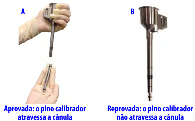
Figura 11.9 Exemplos de aprovação e reprovação com o pino calibrador
