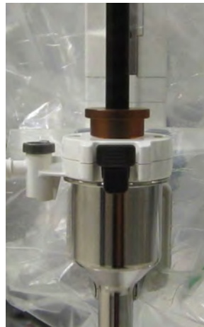
Figura 2.10 Deslizar o introdutor do instrumento eixo abaixo antes da remoção do instrumento
