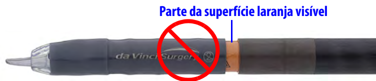
Figura 7.3 Acessório de Cobertura da Ponta instalado incorretamente
