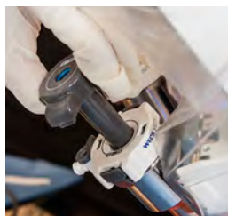
Figura 11.23 Remoção do redutor
