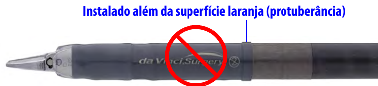
Figura 7.4 Cobertura da Tampa instalada além da posição correta
